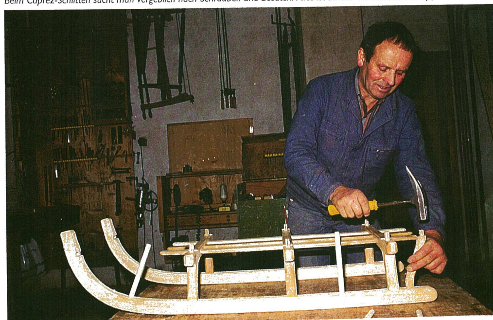
Beim Caprez-Schlitten sucht man vergeblich nach Schrauben und Bostich. Alles ist sauber verkeilt und verzapft.
